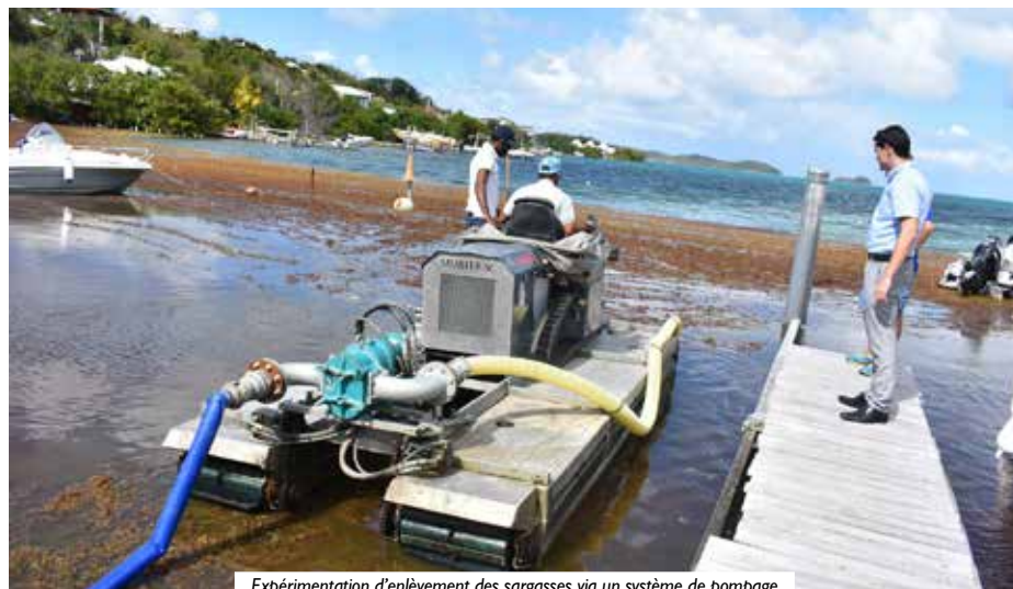
Expérimentation d'enlèvement des sargasses via un système de pompage
